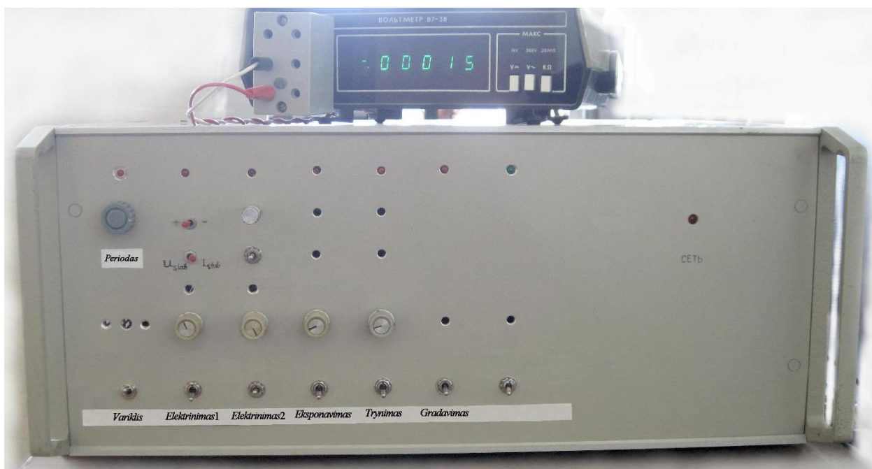
2.2.1 pav. Valdymo bloko priekinio skydelio išvaizda
